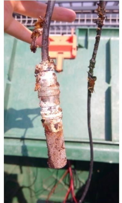
Figure 1 : Sonde interne de température et humidité corrodée en 2 mois d'expérimentation
